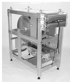
写真 8 ケーブル巻取装置
