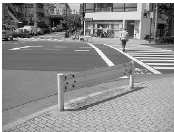
写真 2 縁石や駒止等、他の施設でも代替は可能であり、防護柵は必ずしも必要ない
