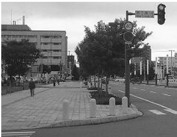
写真 6 歩行者の巻き込み防止を目的として設置される防護柵は、縁石や駒止、高さの低い植樹帯で代替可能
