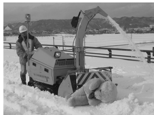
写真 5 オーガ安全カバー機能確認
