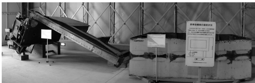
写真 4 老朽化した扉体と兵庫県南部地震で被災した橋脚
