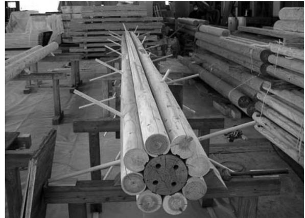
写真 4 間伐材の束ね柱
