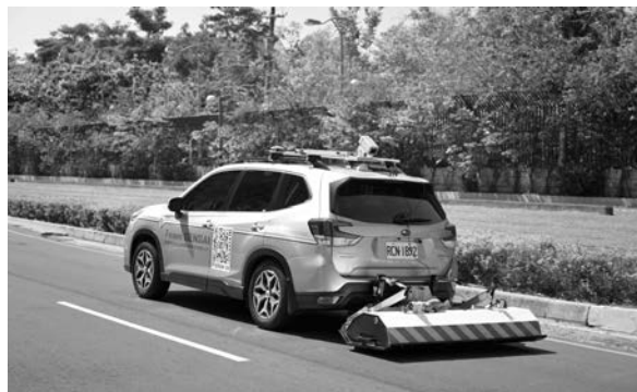
写真-2 台湾向け探査車「スケルカー V TM 」
