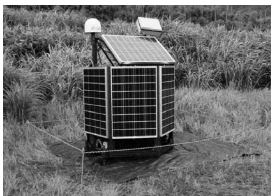
写真－3 悪石島に設置した地殻変動観測装置
