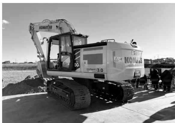
写真－6 「未来の現場」を想像していくソリューション（3Dマシンガイダンス標準装備のバックホウ）
