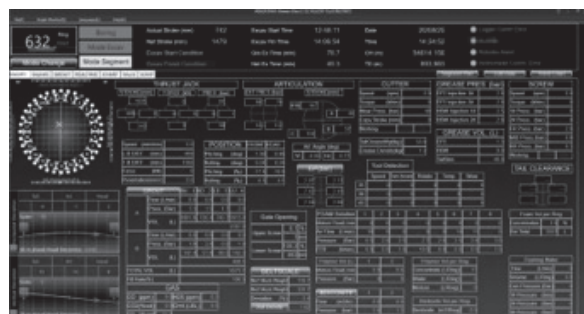
写真－3 トンネル掘進管理システム（日系）
