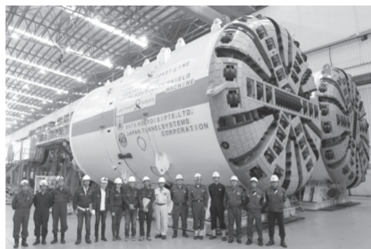
写真－5 シールドマシン工場検査
