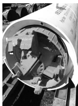
写真－6 引抜型推進機（パイプルーフ工法）
