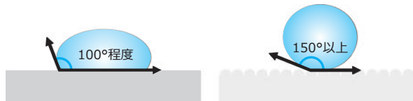
図-1 水滴の接線と表面とのなす角度（左：一般的なフッ素加工の表面，右：HIRECの表面）
