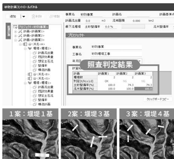
図-9 堰堤配置の比較検討案の照査結果とモデル表示
