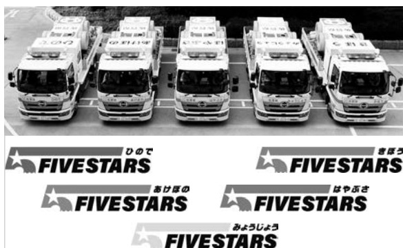
写真-4 排水ポンプ車(ファイブスターズ)
