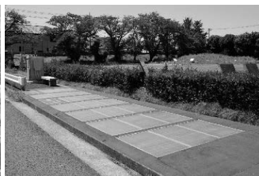
写真－1 走行中給電設備（左）、路面太陽光発電（中央）、ペロブスカイト太陽電池（右）
