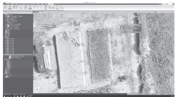
図-3 UAV 測量による混合土量の確認
