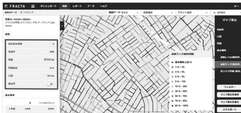
図-2 AI 管路劣化診断結果
