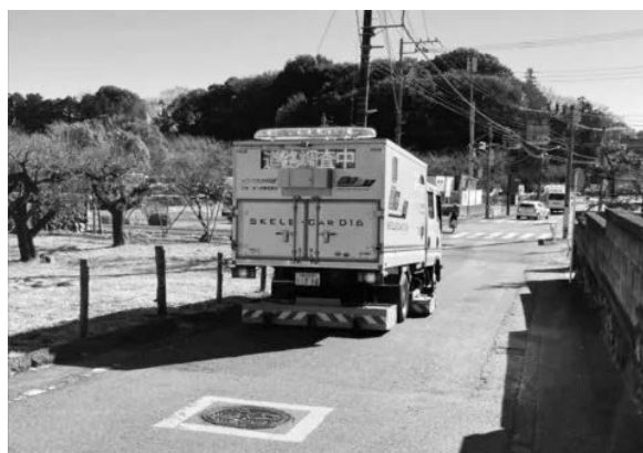
写真-3 路面下空洞調査の様子(空洞探査車による調査)
