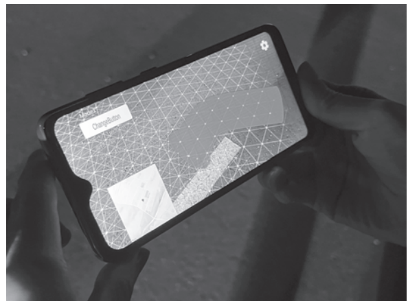
写真-5 湾曲した異形管の表示例
