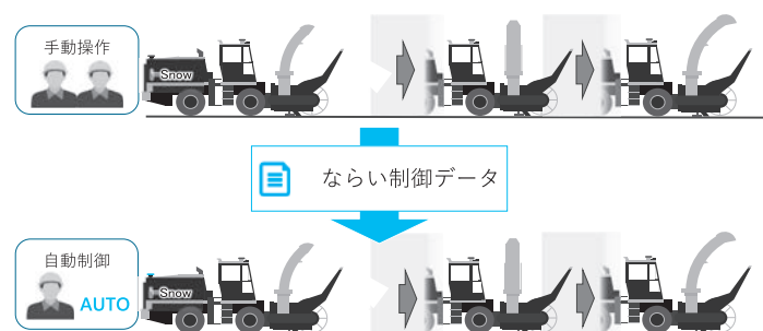
図－6 ならい制御の概念図
