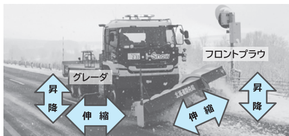
写真-8 高規格道路用除雪トラックの実働状況
