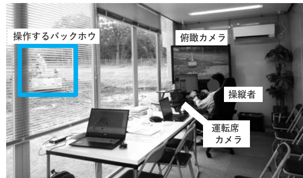
図－4 バックホウを遠隔操縦する様子
