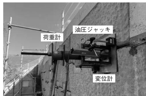
写真-4 リフトオフ試験での载荷および計測装置
