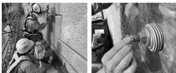
写真-2 超音波探傷の実施状況
