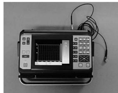
写真-3 使用した超音波探傷器
