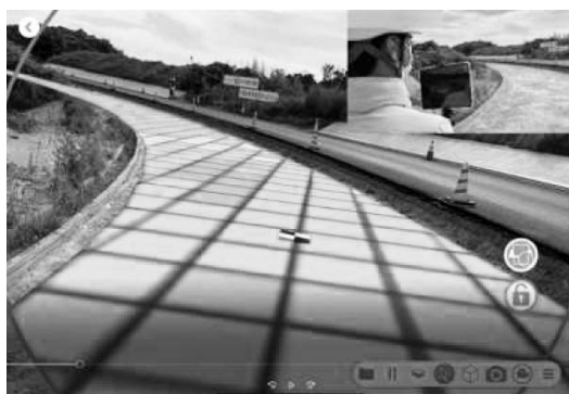
写真-1 AR技術を用いた出来形管理の事例
