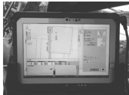
写真－７ バックホウに搭載した ICT 機器
