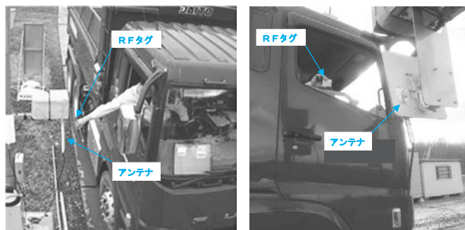
写真－3 運用検証（屋外型）の様子（令和 3 年度）
