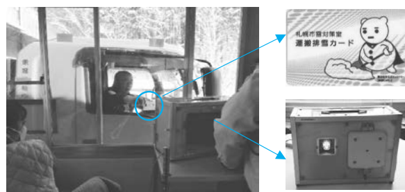
写真－6 室内型認証装置とRFタグを貼付した運搬排雪カード（令和5年度）
