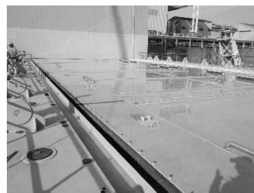
写真－1 工場における製作状況 3) （左：ブロック製作，中：大組立，右：工場水張り・調整・試運転）
