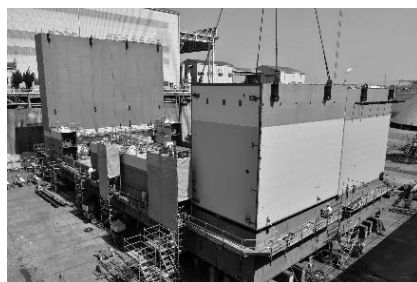
写真－1 工場における製作状況 3) （左：ブロック製作，中：大組立，右：工場水張り・調整・試運転）
