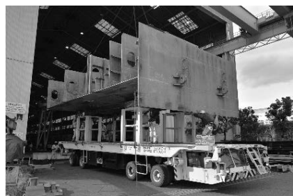
写真－1 工場における製作状況 3) （左：ブロック製作，中：大組立，右：工場水張り・調整・試運転）
