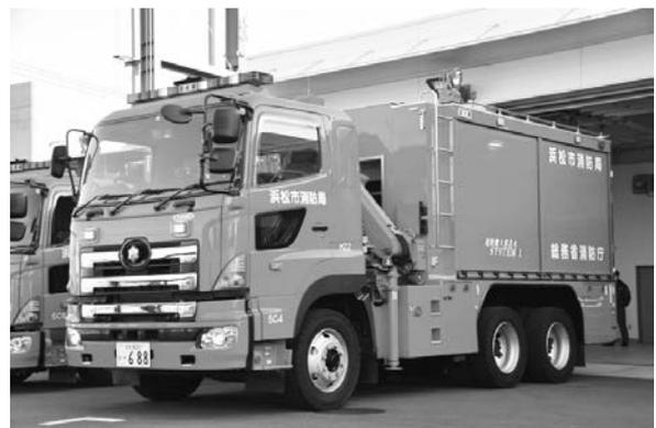
写真－4 海水利用型消防水利システム（スーパーポンパー）
