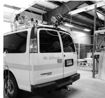
写真－2 カリフォルニア州政府道路構造物点検車両に採用（車両後部に赤外線カメラ）
