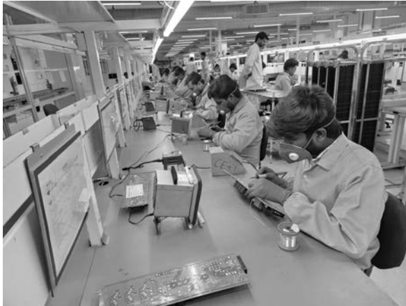
写真－5 プリント基板組立の様子
