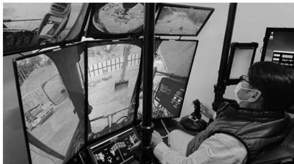
5Gを活用して3種類の建設機械を遠隔操縦する実証実験を開始（日立建機日本株式会社ホームページより）
