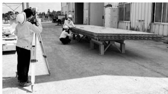
写真-2 製作した床版の計測状況
