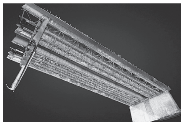
図-7 既設橋梁計測点群データ
