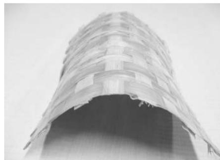
写真-6 竹シートの変形状況
