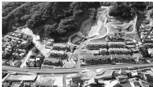
写真-3 国整備の砂防堰堤施設と市整備の広域避難路
