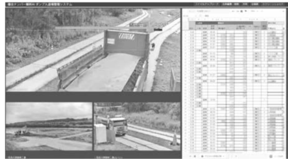
図-7 AI画像解析による自動帳票化
