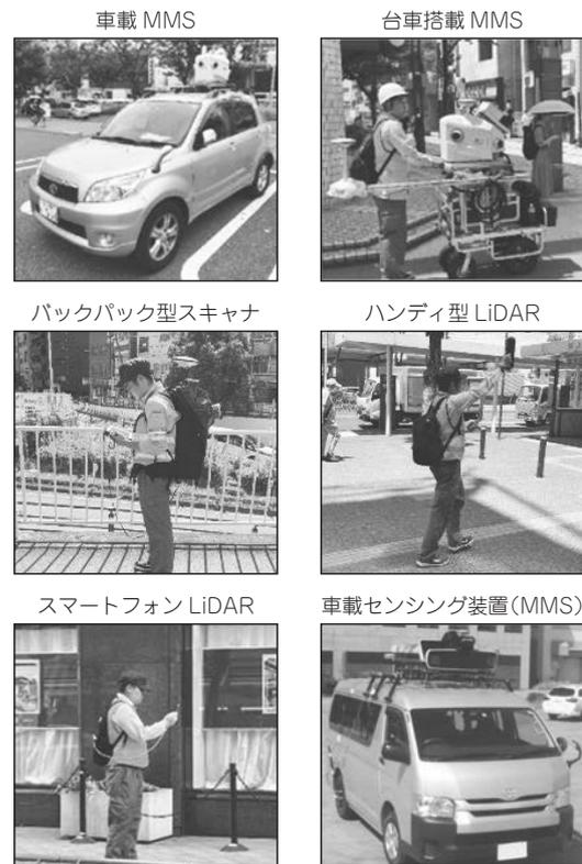
図-3 3次元点群データ取得に使用したセンサー
