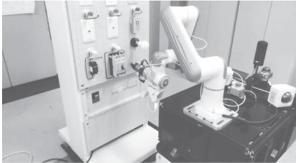
写真-3 スイッチ操作確認状況
