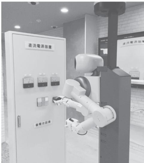
写真-4 切替スイッチ操作確認状況
