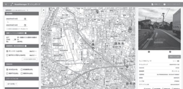
図-6 RoadManager 損傷検知の管理画面
