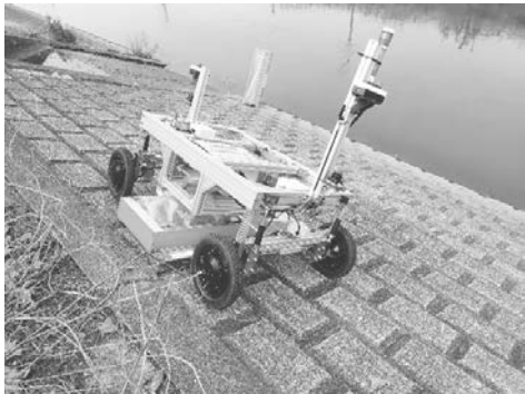
写真-4 カートロボット (探査測線：3 測線)
