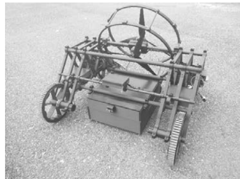
写真-5 壁登りロボット (探査測線：1 測線)
