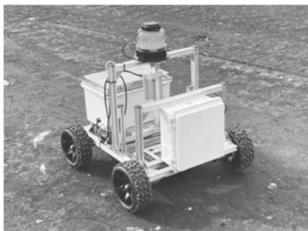
写真一 2 自走式散乱型 RI ロボット (ガンマ線型)
