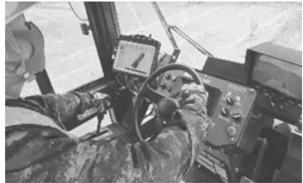
写真-1 振動ローラ加速度応答の計測状況
