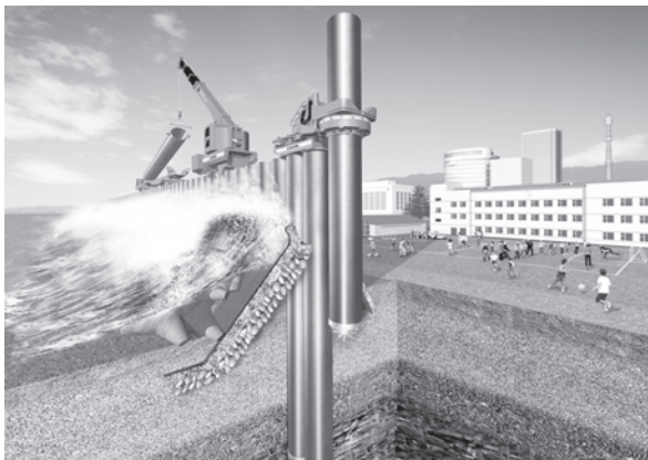
図-4 インプラント堤防のイメージ
