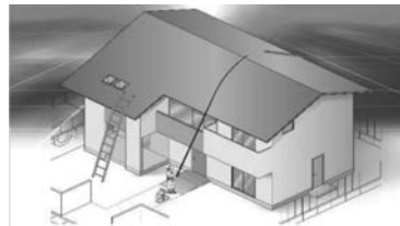
図-5 地上からの主網設置手順
