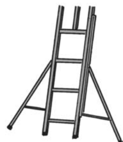
安定性補助金具で安定させる一例
