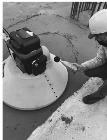
写真-8 発生音の測定状況
