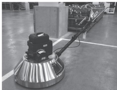
写真－10 防音カバー付き電動ハンドトロウエル
