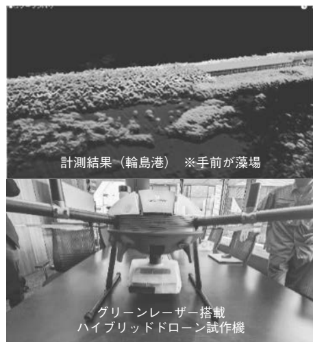
写真-2 グリーンレーザー搭載ドローンや計測結果
