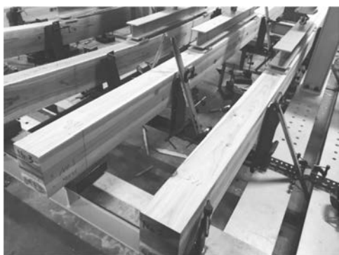
写真－1 炭素繊維束挿入集成材のクリープ試験
