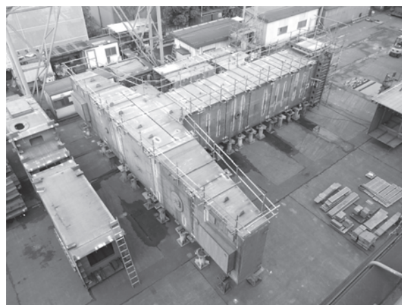
写真-2 角型鋼橋脚
