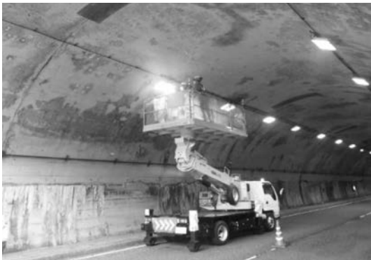
写真－24 高所作業車（トラック架装）伸縮ブーム・プラットフォーム型
