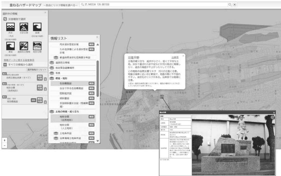
図-4 重ねるハザードマップ（地形分類，色別標高図，自然災害伝承碑を表示）
