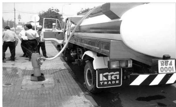
写真-2 消火栓からの盗水被害
