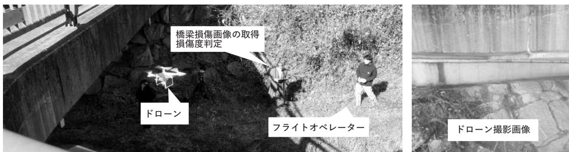
写真-3 実際の橋梁を用いた検証の様子
