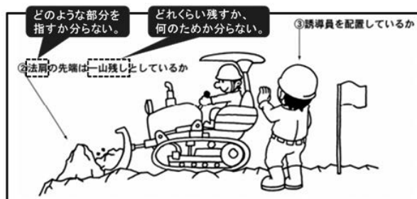
図－2 『建設機械施工安全マニュアル』 p32 ブルドーザ掘削での理解困難点
