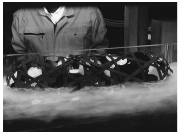
写真-4 竹蛇籠周辺の流れの可視化実験
