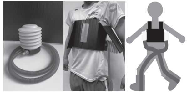
図-5 ポンプを使った泥長靴システム
